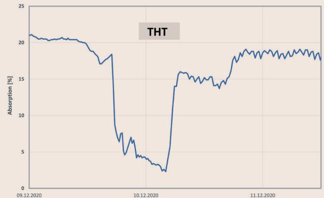
Bild 5: Konzentrationsverlauf bei Störung der Odorierung
