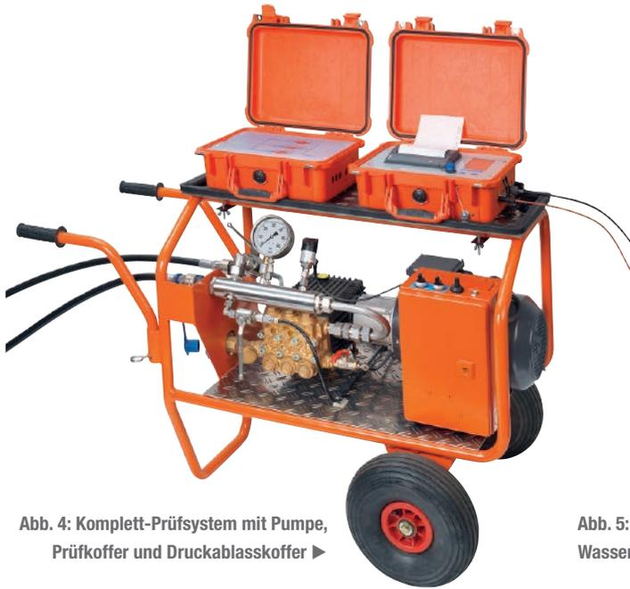
**Abb. 4: Komplett-Prüfsystem mit Pumpe, Prüfkoffer und Druckablasskoffer ▶**
