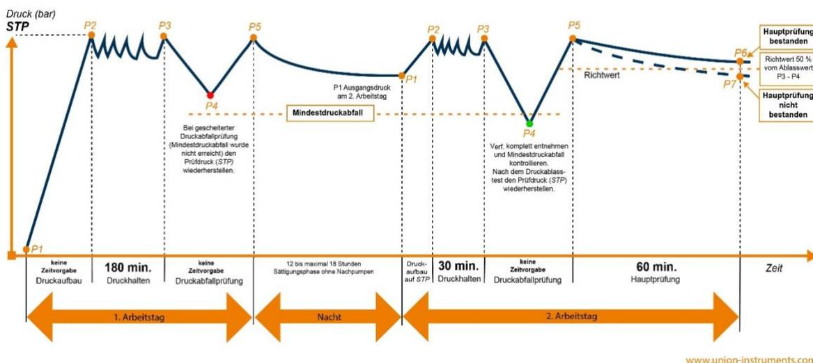
**7.8.1 Beschleunigtes Normalverfahren/DVM für Gusseisen/Stahl mit Zementmörtelauskleidung**
